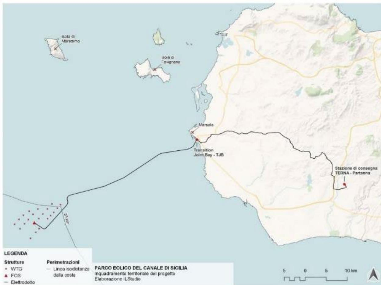
Figura 11: Tracciato elettrodotta.
