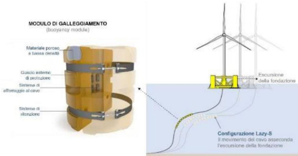
Figura 5: Schema Collegamento elettrico Flottante
